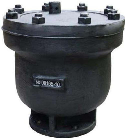
*Вантузы предназначены для автоматического удаления воздуха в трубопроводе, а также для его автоматического впуска при образовании вакуума. Воздух, скапливающийся в водопроводе, уменьшает его пропускную способность, нарушает работу насосов и является одной из причин гидравлических ударов при аварийном отключении насосной станции. В настоящее время «Завод «Водоприбор» выпускает 2 типа вантузов: ВМТ и В6.*
